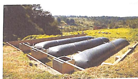
4.5-rasm. Qattiq xom-ashyoda ishlaydigan biogaz qurilmasi (yuqorida), plenkali quvurda biogaz hosil qilsish (pastda).
