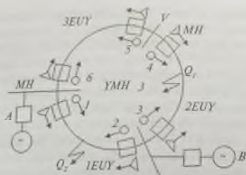
104-rasm. Ikki manbali uchta aylanasimon elektr uzatish yo'li:
