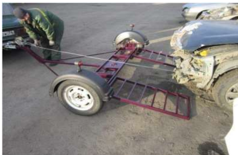
7.26-расм. Шатакка олиш арачаси ёрдамида қисман ортиш усули билан енгил автомобилни эвакуация қилиш.
