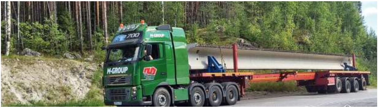
б) Курилиш материаллари: темир-бетонли тўсин ташувчи автопоезд
