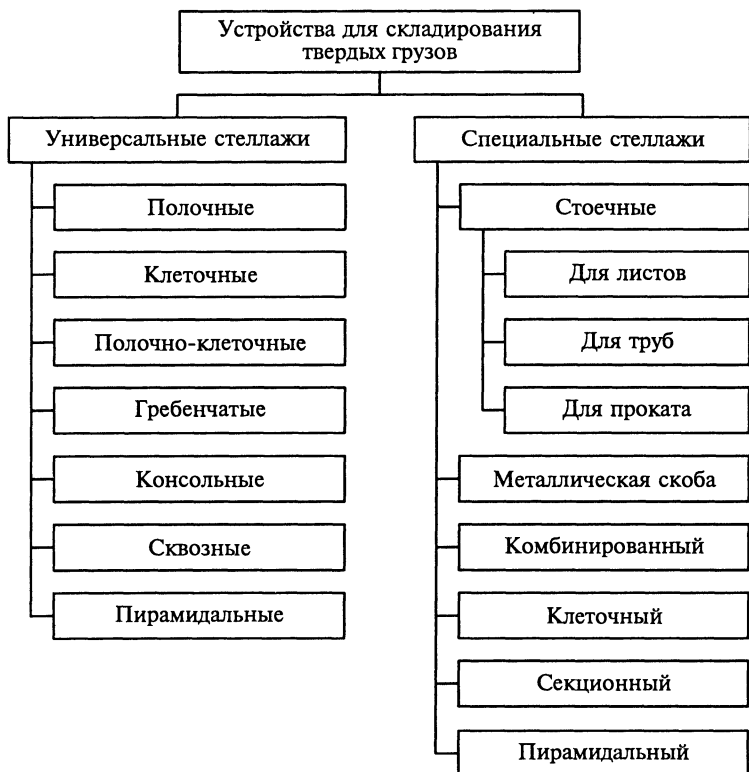
Рис. 5.9. Устройства для складирования твердых грузов
