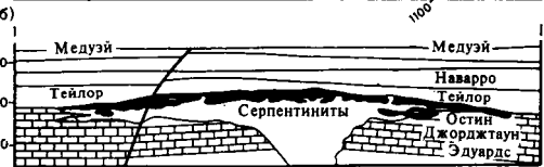
Рис. 7.67. Местоскопление Литтон-Спрингс (по Лахи и Вер-Вибе, 1952): а — структурная карта; б — разрез; 1 — изогипсы по кровле серпентинита; 2 — изогипсы по кровле меловых отложений
