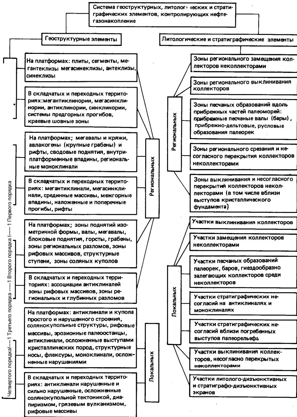
Рис. 6.1. Схема геоструктурных элементов, контролирующих регионально нефтегазоносные провинции
