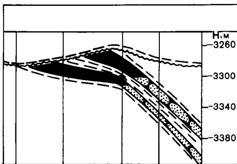
Рис. 10.18. Местоскопление Озек-Суат Структурно-стратиграфические залежи нефти во II и III пластах средней юры
