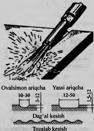
8.7-rasm. Kislorod yordamida yuza kesish va kesib o‘yilayotgan ariqchalarning shakllari.
