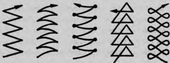
4.6-rasm. Yoy bilan qo'lda payvandlashda elektrod uchlarning harakat traektoriyasi.
